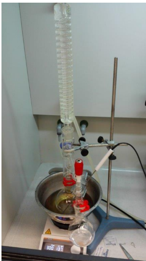
Figura 3. Equipo de destilación Dean-Stark
