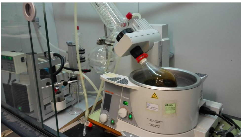
Figura 23. Concentración de la fase glicerina en rotavapor.
