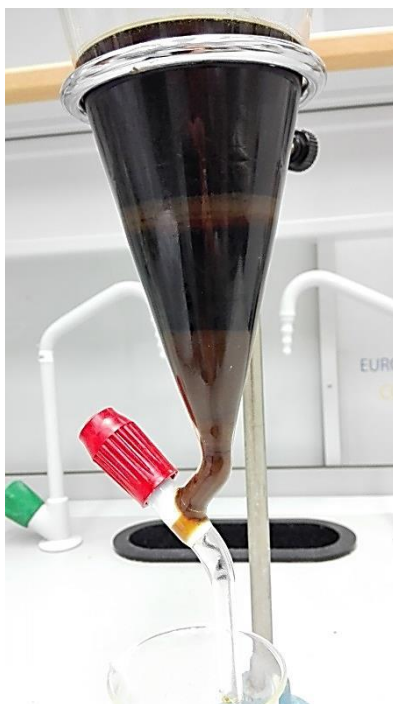
Figura 17. Obtención de fases durante el proceso de decantación. Fase inferior: Fase glicerina. Fase superior: Fase biodiésel.
