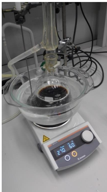
Figura 13. Dispositivo experimental para llevar a cabo la reacción de transesterificación.
